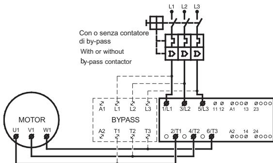
**Collegamento standard di un softstarter per un motore a 6 fili**
