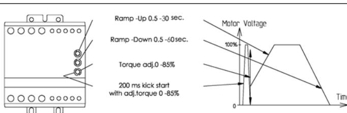
Il controllo della coppia del motore è realizzata regolando la tensione del motore. La velocità dipende dalla coppia prodotta dal motore e dal carico applicato sull'albero del motore. Un motore con un piccolo o senza carico raggiungerà la massima velocità prima che la tensione abbia raggiunto il valore massimo.
