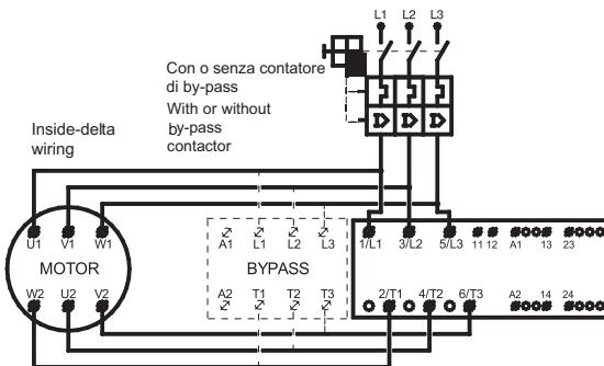
**PROTEZIONE TERMICA DI SOVRACCARICO - THERMAL OVERLOAD PROTECTION**
