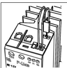
La protezione termica di sovraccarico è ottenuta inserendo un termostato nell'apposito alloggiamento nella parte destra del gruppo statico. Il gruppo statico accetta 2 tipi di termostati : TO6290.
