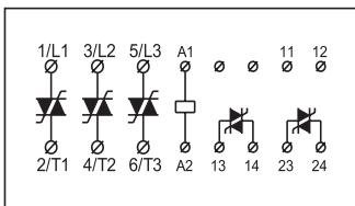
Morsetti di potenza 1/L1-2/T1&3/L2-4/T2&5/L3-6/T3 Morsetti di pilotaggio A1-A2.
