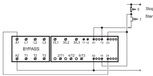
**Collegamento standard di un softstarter per un motore trifase**
